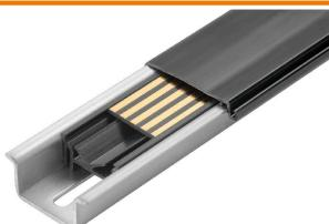
El bus de carril integrado para el sistema modular de carcasa para componentes electrónicos. Al alimentar, conectar o distribuir dentro de aplicaciones modulares, el bus de carril puede sustituir el tedioso proceso de cableado individual por una solución flexible y continua a nivel de sistema.
