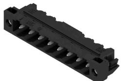
Conecotor macho resistente a altas temperaturas, embalado en caja o cinta. En cinta, con pin de soldadura de 1,5 mm, optimizado para el montaje automático. Pin de soldadura de 3,2 mm, indicado para soldadura reflow y por ola. Los conectores macho disponen de espacio para señalización y se pueden codificar. HC = Alta intensidad
