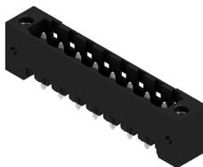
Conejero macho resistente a altas temperaturas, embalado en caja o cinta. En cinta, con pin de soldadura de 1,5 mm, optimizado para el montaje automático. Pin de soldadura de 3,2 mm, indicado para soldadura reflow y por ola. Los conectores macho disponen de espacio para señalización y se pueden codificar. HC = Alta intensidad
