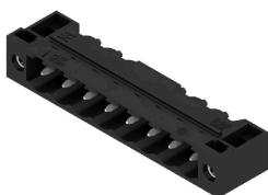
Conejero macho resistente a altas temperaturas, embalado en caja o cinta. En cinta, con pin de soldadura de 1,5 mm, optimizado para el montaje automático. Pin de soldadura de 3,2 mm, indicado para soldadura reflow y por ola. Los conectores macho disponen de espacio para señalización y se pueden codificar. HC = Alta intensidad
