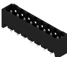
Conejor macho resistente a altas temperaturas, embalado en caja o cinta. En cinta, con pin de soldadura de 1,5 mm, optimizado para el montaje automático. Pin de soldadura de 3,2 mm, indicado para soldadura reflow y por ola. Los conectores macho disponen de espacio para señalización y se pueden codificar. HC = Alta intensidad
