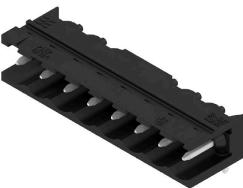
Conecotor macho resistente a altas temperaturas, acodado 90°, abierto. Embalaje en caja o cinta. En cinta, con pin de soldadura de 1,5 mm, optimizado para el montaje automático. Pin de soldadura de 3,2 mm, indicado para soldadura reflow y por ola. Los conectores macho disponen de espacio para señalización y se pueden codificar. HC = Alta intensidad
