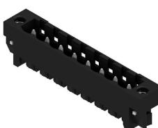
Conecotor macho resistente a altas temperaturas, embalado en caja o cinta. En cinta, con pin de soldadura de 1,5 mm, optimizado para el montaje automático. Pin de soldadura de 3,2 mm, indicado para soldadura reflow y por ola. Los conectores macho disponen de espacio para señalización y se pueden codificar. HC = Alta intensidad
