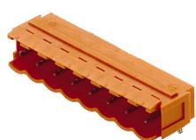
Conecotores macho con dirección de salida 90°. La longitud del terminal de soldadura está optimizada para la utilización de soldadura por ola. Los conectores macho ofrecen espacio para rotulación y se pueden codificar.
