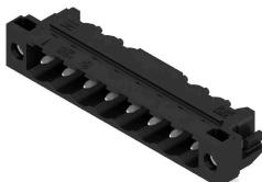
Conector macho resistente a altas temperaturas, embalado en caja o cinta. En cinta, con pin de soldadura de 1,5 mm, optimizado para el montaje automático. Pin de soldadura de 3,2 mm, indicado para soldadura reflow y por ola. Los conectores macho disponen de espacio para señalización y se pueden codificar. HC = Alta intensidad
