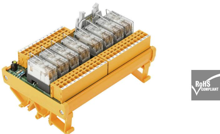
Bases de relés(RSM) en positivo y negativo común para ser conectadas a PLC u otro tipo de controladores. Los interfaces están compuestos por grupos de 4,8 o 16 relés RCL (12.7mm) o RSS (6,1mm). La conexión al controlador puede ser realizada mediante conectores enchufables o mediante cableado directo con conectores IEC 60603-13. Amplia gama de opciones:
