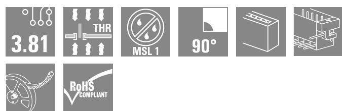
Conector macho resistente a altas temperaturas (SC-SMT 90LF) con paso de 3,81 mm (0,15 pulgadas)
