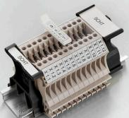
El portaequetas para conjuntos SchT 5 se enclavará directamente en el carril TS 32 (guía perfil asimétrico) o en el carril TS 35 (guía perfil simétrico). De esta forma la regleta de bornes puede identificarse con una etiqueta independientemente de los bornes incluidos en la regleta.
