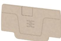
Las tapas de cierre se sujetan en la parte abierta del último borne antes del ángulo de fijación lateral. El empleo de la tapa de cierre permite mantener la función del borne así como la tensión nominal indicada. Además, garantiza una protección de contacto para las partes que soportan tensión. El borne final es a prueba de contacto con los dedos.
