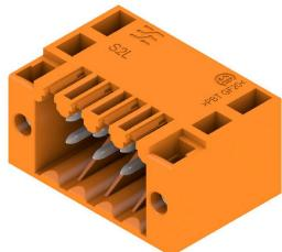
Conectores macho acodados de dos filas en las variantes con lateral cerrado o con brida (conectores macho con lateral abierto, bajo pedido). Los conectores macho con terminal de 3,5 mm están diseñados para soldadura por ola y se presentan empaquetados en caja. Se puede atornillar en la placa c.i. Los conectores macho ofrecen espacio para rotulación y se pueden codificar.
