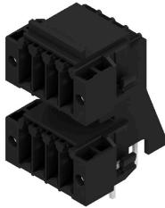
El nuevo referente en densidad de componentes: la distancia virtual entre contactos de 0,875 mm, para conexiones E/S de 1 mm<sup>2</sup>. Los únicos conectores macho de doble nivel en 4 filas para interfaces de sensores estándar IP20 con paso de 3,5 mm. El S2L en formato doble: un estándar que se ha superado a sí mismo.
