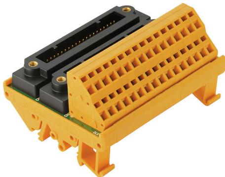
Los interfaces analógicos son suministrados con conectores de 40 polos (KS). Existen versiones con seccionadores y puntos de prueba muy útiles para la medida de tensión o corriente. También hay versiones con espadín muy útil si el cliente desea incorporar algún tipo de elemento (resistencia...) para realizar conversiones tensión/corriente o monitorización del bucle de corriente.
