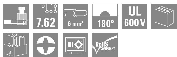
Conector hembra de 180° con un paso de 7,62 para redes TI. Cumple los requisitos de la norma UL1059 600 V, clase C. En combinación con el conector macho SV 7.62 IT.. con contacto en avance.
