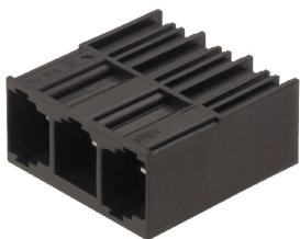
Conector macho para alta intensidad, de una hilera, para montaje en serie sin pérdida de polos o con sujeción patentada para enclavamiento rápido sin herramientas. La mejor fiabilidad de maniobra y funcionamiento gracias a una cara enchufable que impide errores de conexión, con diversidad de codificación única y sujeción adicional. La longitud del pin de 3,5 mm está optimizada para soldadura por ola, con dirección de montaje de 90° a los pines de soldadura.
