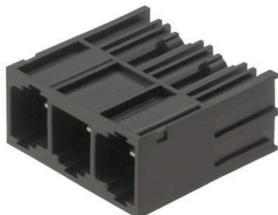
Conector macho de alto rendimiento, de una hilera, para montaje en serie sin pérdida de polos o con sujeción patentada para enclavamiento rápido sin herramientas. La mejor fiabilidad de maniobra y funcionamiento gracias a una cara enchufable que impide errores de conexión, con diversidad de codificación única y sujeción adicional. La longitud del pin de 3,5 mm está optimizada para soldadura por ola, con dirección de montaje de 270° a los pines de soldadura.
