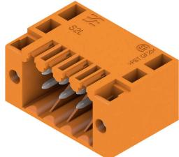
Conectores macho acodados de dos filas en las variantes con lateral cerrado o con brida (conectores macho con lateral abierto, bajo pedido). Los conectores macho con terminal de 3,5 mm están diseñados para soldadura por ola y se presentan empaquetados en caja. Se puede atornillar en la placa c.i. Los conectores macho ofrecen espacio para rotulación y se pueden codificar.
