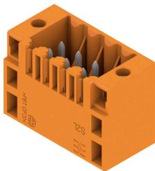
Conector macho de dos filas disponible con lateral cerrado o con sujeción lateral (conectores macho con lateral abierto, bajo demanda). Los conectores macho con una longitud de pin superior a 3,5 mm están diseñados para soldadura por ola y se presentan embalados en caja. Se pueden atornillar sobre la placa de circuito impreso. Los conectores macho disponen de espacio para señalización y codificación.
