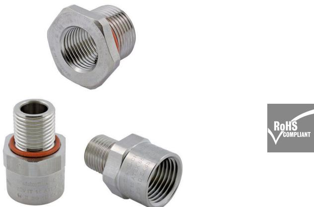
Los adaptadores de la serie ADAP ofrecen flexibilidad y versatilidad para llenar las entradas no utilizadas en equipos con clasificación Ex y mantener la protección antideflagrante Ex d y la protección de explosión de seguridad mejorada Ex e, así como los niveles de protección IP66/67/68.
