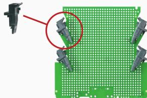
Conector macho abierto, recto y resistente a altas temperaturas. Embalaje en caja o cinta. En cinta, con pin de soldadura de 1,5 mm, optimizado para el montaje automático. Pin de soldadura de 3,2 mm, indicado para soldadura reflow y por ola. Los conectores macho disponen de espacio para señalización y se pueden codificar. HC = Alta intensidad
