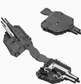
El soporte de fusible SIHA convierte rápidamente un borne seccionable en un borne portafusibles: sólo es necesario retirar la palanca de desconexión e insertar el enchufe con fusible.
