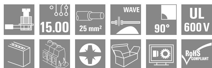
Equipado con brida para soportar fuerza y permitir la fijación a la placa de circuitos impresos. Este borne para placas de circuitos impresos admite conductores de 101 A, 1000 V y sección de 25 mm<sup>2</sup>. Conexión brida-tornillo probada con paso de 15,00 mm, dirección de salida del conductor de 90° y toma de prueba.
