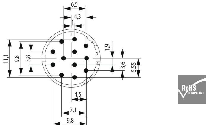
Los conectores circulares M23 ofrecen una elevada frecuencia de ciclos de enchufado/desenchufado, alta carga de intensidad admisible y gran densidad de contactos en unas dimensiones mínimas.
