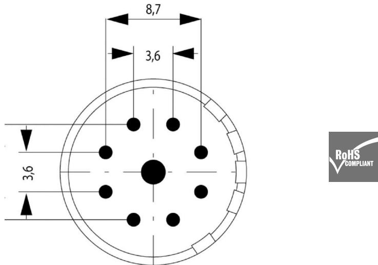
Los conectores circulares M23 ofrecen una elevada frecuencia de ciclos de enchufado/desenchufado, alta carga de intensidad admisible y gran densidad de contactos en unas dimensiones mínimas.
