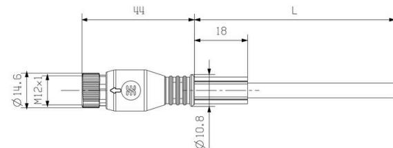
**Dibujo acotado****Esquema de conexiones**
