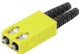
Conector de fibra óptica SC-RJ según IEC 61754-24 para diámetro externo del conductor 2,6...3 mm
