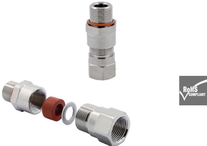
Los prensaestopas A2LC son ideales para cables sin blindaje y proporcionan rosca hembra para la conexión de conductos. Además, mantienen el nivel de protección antideflagrante Ex d y la protección de explosión de seguridad mejorada Ex e.
