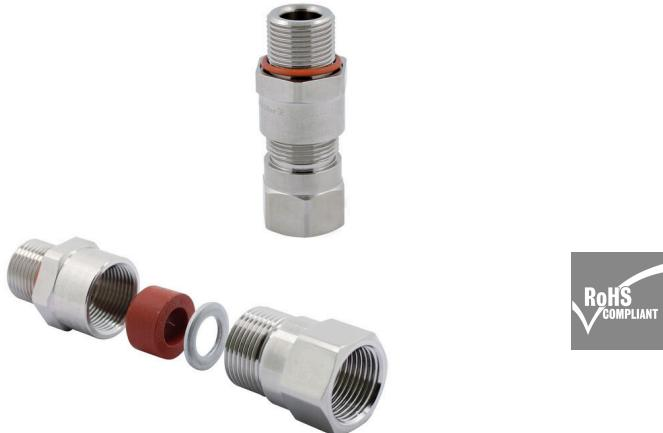
Los prensaestopas A2LC son ideales para cables sin blindaje y proporcionan rosca hembra para la conexión de conductos. Además, mantienen el nivel de protección antideflagrante Ex d y la protección de explosión de seguridad mejorada Ex e.
