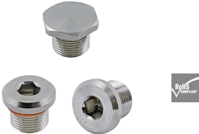
Los tapones de la serie VP permiten llenar las entradas no utilizadas en equipos con clasificación Ex y mantener la protección antideflagrante Ex d y la protección de explosión de seguridad mejorada Ex e, así como los niveles de protección IP66/67/68.
