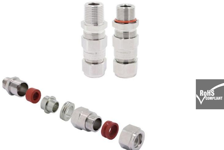
Los prensaestopas E1XZ son ideales para cables de acero trenzado SWB o cables con blindaje de acero STA. Asimismo, mantienen el nivel de protección antideflagrante Ex d y la protección de explosión de seguridad mejorada Ex e. Además, la protección del blindaje proporciona una conexión eléctrica entre el blindaje del cable y los prensaestopas.
