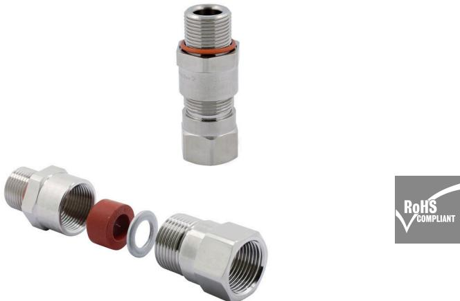
Los prensaestopas A2LC son ideales para cables sin blindaje y proporcionan rosca hembra para la conexión de conductos. Además, mantienen el nivel de protección antideflagrante Ex d y la protección de explosión de seguridad mejorada Ex e.
