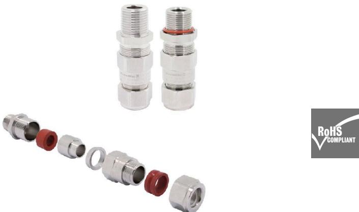
Los prensaestopas E1W son ideales para cables con blindaje de acero SWA. Asimismo, mantienen el nivel de protección antideflagrante Ex d y la protección de explosión de seguridad mejorada Ex e. Además, la protección del blindaje proporciona una conexión eléctrica entre el blindaje del cable y los prensaestopas.
