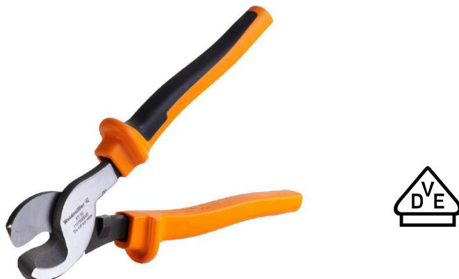
Herramientas para cortar cables de hasta 8 mm, 12 mm, 14 mm y 22 mm de diámetro exterior. La geometría especial de la cuchilla permite un corte sin estrangulamiento de conductores de cobre y aluminio, con esfuerzo físico mínimo. Las herramientas para cortar (KT 8 to KT 22) incluyen además aislamiento de protección sometido a pruebas VDE y GS de hasta 1.000 V de conformidad con la normativa EN/IEC 60900.
