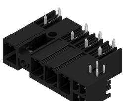
Combinación de conector macho de 270° con contactos de potencia y señal, incl. enclavamiento mediante sujeción intermedia con autobloqueo, con un paso de 7,62.
