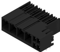
Combinación de conector macho de 90° con contactos de potencia y señal, con conexión PUSH IN, incl. enclavamiento mediante sujeción intermedia con autobloqueo y conexión de apantallamiento insertable (opcional) con un paso de 7,62.
