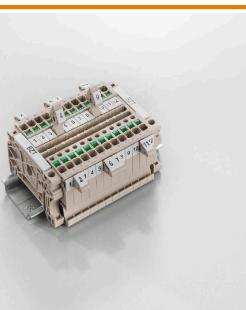
El soporte para señalizadores ofrece la posibilidad de montar adicionalmente señalizadores estándar con un paso de 5 ó 5,1 mm. Los soportes acodados se pueden encajar opcionalmente y se pueden montar en todos los canales de señalización estándar de los bornes modulares Klippon® Connect. Los tipos de señalizadores de ajuste se pueden encontrar en los respectivos accesorios del soporte de señalización.
