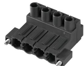
Conector macho invertido de 180° con conexión brida-tornillo para cables de hasta 2,5 mm<sup>2</sup> con un paso de 7,62. También ideal como solución con protección frente al contacto con los dedos para tensiones inversas. Cumple los requerimientos de las normas UL 1059 600 V, clase C, e IEC 61800-5-1. Variantes: disponible sin fijación lateral, con fijación externa o con gancho de fijación.
