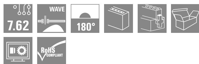
Conecotor hembra de 180° para la placa de circuito impreso con un paso de 7,62. Cumple los requerimientos de la norma IEC 61800-5-1 y admite homologación UL conforme a UL840 600 V. Solución perfecta, con protección frente al contacto con los dedos, para la salida de potencia y aplicaciones de circuito intermedio.
