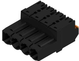
Conector macho invertido de 180° con conexión PUSH IN para cables de hasta 2,5 mm<sup>2</sup> con un paso de 7,62. También ideal como solución con protección frente al contacto con los dedos para tensiones inversas. Cumple los requerimientos de las normas UL 1059 600 V, clase C, e IEC 61800-5-1. Variantes: disponible sin fijación lateral, con fijación externa o con gancho de fijación.
