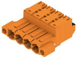
Conector macho invertido de 180° con conexión PUSH IN para cables de hasta 2,5 mm<sup>2</sup> con un paso de 7,62. También ideal como solución con protección frente al contacto con los dedos para tensiones inversas. Cumple los requerimientos de las normas UL 1059 600 V, clase C, e IEC 61800-5-1. Variantes: disponible sin fijación lateral, con fijación externa o con gancho de fijación.
