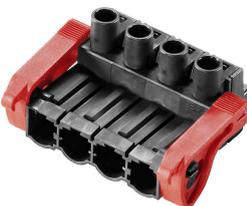
Conector macho invertido de 180° con conexión brida-tornillo para cables de hasta 2,5 mm<sup>2</sup> con un paso de 7,62. También ideal como solución con protección frente al contacto con los dedos para tensiones inversas.
