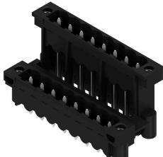
Conecotor macho resistente a altas temperaturas, de doble piso, desplazado lateralmente con brida o brida para soldadura. Terminal de soldadura de 1,5 mm idóneo para aplicaciones de soldadura reflow. Terminal de soldadura de 3,2 mm idóneo para soldadura Reflow y por ola. Los conectores macho ofrecen espacio para rotulación y se pueden codificar.
