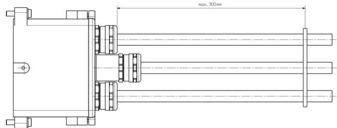
Para evitar que se dañen los contactos y los manguitos aislantes, recomendamos fijar el cable.
