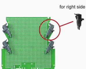
Conectores macho con longitud de terminal de soldadura optimizada para aplicación de soldadura por onda. Los conectores macho ofrecen espacio para rotulación y se pueden codificar.
