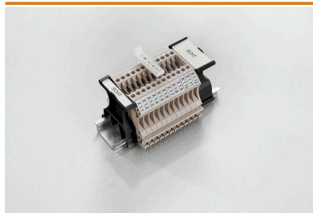
El portaequetas para conjuntos <B>SchT 5</B> se enclavará directamente en el carril TS 32 (guía perfil asimétrico) o en el carril TS 35 (guía perfil simétrico). De esta forma la regleta de bornes puede identificarse con una etiqueta independientemente de los bornes incluidos en la regleta.
