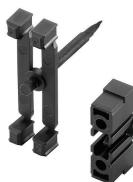
Mediante el KIT DE ACOPLAMIENTO SVF/BVF 7.62HP se pueden conectar dos elementos enchufables "espalda contra espalda" para formar un conector de 2 filas, con un máximo de 2 x 4 polos.
