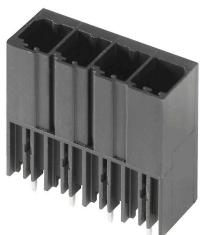
Conector macho de alto rendimiento, de una hilera, para montaje en serie sin pérdida de polos o con sujeción patentada para enclavamiento rápido sin herramientas. La mejor fiabilidad de maniobra y funcionamiento gracias a una cara enchufable que impide errores de conexión, con diversidad de codificación única y sujeción adicional. La longitud del pin de 3,5 mm está optimizada para soldadura por ola sin plomo.
