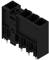
Conector macho de 180° con sujeción intermedia de 7,62 de paso. Cumple los requerimientos de IEC 61800-5-1 y admite homologación UL conforme a UL840 600 V.
