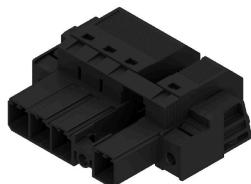
Conector macho invertido de 180° con conexión PUSH IN para cables de hasta 6 mm<sup>2</sup>, con un paso de 7,62, y tres puntos de fijación. Apto para carcasa con grosor de pared máx. de 16 mm. También es ideal como solución de protección frente a contacto con los dedos para tensiones inversas. Cumple los requerimientos de las normas UL 1059 600 V, clase C, e IEC 61800-5-1.
