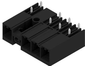
Conector macho de 270° con sujeción intermedia de 7,62 de paso. Cumple los requerimientos de la norma IEC 61800-5-1 y admite homologación UL conforme a UL840 600 V. Sin un conector hembra, la cara enchufable garantiza una protección frente al contacto con los dedos mínima de >3 mm con 20 N de presión en el ensayo.
