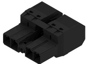
Conector macho invertido de 180°, con seguro contra voltaje inverso, con conexión PUSH IN. Con sujeción intermedia con autobloqueo para cables de hasta 6 mm<sup>2</sup>, con un paso de 7,62. También ideal como solución con protección frente al contacto con los dedos para tensiones inversas. Cumple los requerimientos de las normas UL 1059 600 V, clase C, e IEC 61800-5-1. Bajo pedido, también disponible sin sujeción intermedia.
