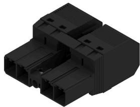
Conector macho invertido de 180°, con seguro contra voltaje inverso, con conexión PUSH IN. Con sujeción intermedia con autobloqueo para cables de hasta 6 mm<sup>2</sup>, con un paso de 7,62. También ideal como solución con protección frente al contacto con los dedos para tensiones inversas. Cumple los requerimientos de las normas UL 1059 600 V, clase C, e IEC 61800-5-1. Bajo pedido, también disponible sin sujeción intermedia.
