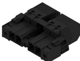
Conector macho invertido de 180° con conexión PUSH IN para cables de hasta 6 mm<sup>2</sup>, con un paso de 7,62, y tres puntos de fijación. Apto para carcasa con grosor de pared máx. de 2 mm. También es ideal como solución de protección frente a contacto con los dedos para tensiones inversas. Cumple los requerimientos de las normas UL 1059 600 V, clase C, e IEC 61800-5-1.
