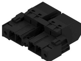
Conector macho invertido de 180° con conexión PUSH IN para cables de hasta 6 mm<sup>2</sup>, con un paso de 7,62, y tres puntos de fijación. Apto para carcasa con grosor de pared máx. de 2 mm.
