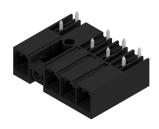
Conector macho de 270° con sujeción intermedia de 7,62 de paso. Cumple los requerimientos de la norma IEC 61800-5-1 y admite homologación UL conforme a UL840 600 V. Sin un conector hembra, la cara enchufable garantiza una protección frente al contacto con los dedos mínima de >3 mm con 20 N de presión en el ensayo.
