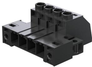
Conector macho de alto rendimiento con la reconocida conexión brida-tornillo de acero y totalmente exenta de mantenimiento de Weidmüller. Montaje en serie sin pérdida de polos o con sujeción multifunción patentada para un enclavamiento seguro, rápido y sin herramientas. La mejor fiabilidad de maniobra y funcionamiento gracias a una cara enchufable que impide errores de conexión, con diversidad de codificación única, protección contra cableado erróneo. Apto para señalización.
