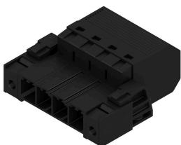
Conector macho invertido de 180°, con conexión PUSH IN, para cableado de campo, de hasta 6 mm<sup>2</sup>, con paso de 7,62, como "variante de tres sujetaciones" para pasamuros en cajas. Indicado para cajas con un grosor de pared máx. de 2 mm. También es ideal como solución de protección frente a contacto con los dedos para tensiones inversas. Cumple los requerimientos de las normas UL1059 600 V Class C e IEC 61800-5-1.
