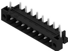
Conecotor macho abierto, recto y resistente a altas temperaturas. Embalaje en caja o cinta. En cinta, con pin de soldadura de 1,5 mm, optimizado para el montaje automático. Pin de soldadura de 3,2 mm, indicado para soldadura reflow y por ola. Los conectores macho disponen de espacio para señalización y se pueden codificar. HC = Alta intensidad
