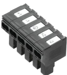
Distribución de energía con conductores sin cortar con secciones de entre 1,5 y 6 mm<sup>2</sup>. Alimentación / derivación en T con conexión PUSH IN de 0,5 a 10 mm<sup>2</sup> y/o conexión enchufable de 0,5 a 4 mm<sup>2</sup>. Los señalizadores de colores permiten una clara diferenciación de cables.
