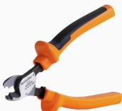
Herramientas para cortar cables de hasta 8 mm, 12 mm, 14 mm y 22 mm de diámetro exterior. La geometría especial de la cuchilla permite un corte sin estrangulamiento de conductores de cobre y aluminio, con esfuerzo físico mínimo. Las herramientas para cortar (KT 8 to KT 22) incluyen además aislamiento de protección sometido a pruebas VDE y GS de hasta 1.000 V de conformidad con la normativa EN/IEC 60900.
